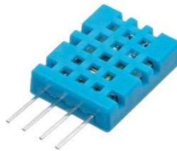
**Figure 1.** DHT11 sensor
